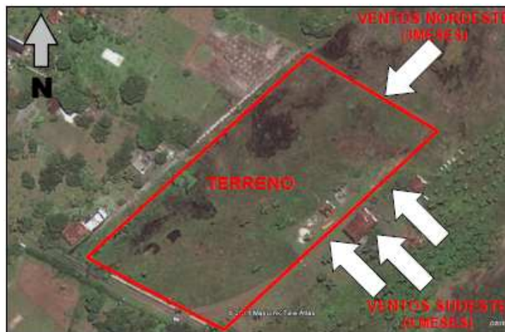
FIGURA 33: Estudo da Ventilação FONTE: Desenvolvido pela autora,2011.
