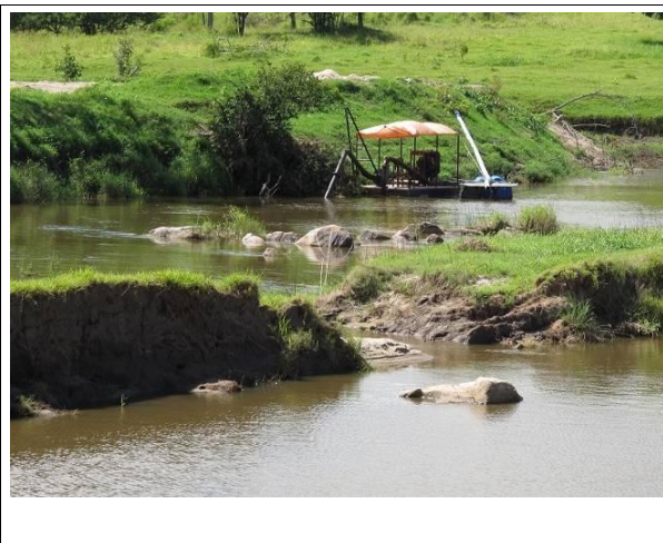
Figura 24: Draga extraindo areia na Barra do Riachão, em São Joaquim do Monte, PE, divisa com Agrestina. A areia é depositada no terreno às margens do rio. O leito do rio está em primeiro plano e a draga já formou lagoas, às margens do rio, com extensa degradação ambiental (foto: do próprio autor).
