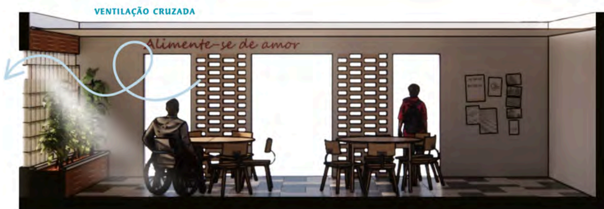
Ilustração 3 33 — Corte esquemático com indicação de ventilação cruzada na proposta do refeitório. 34
